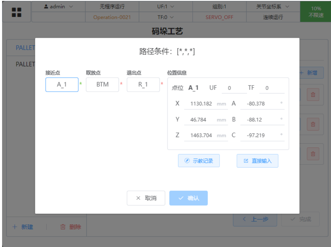
图 8.30 码垛工艺路径样式设置页面
