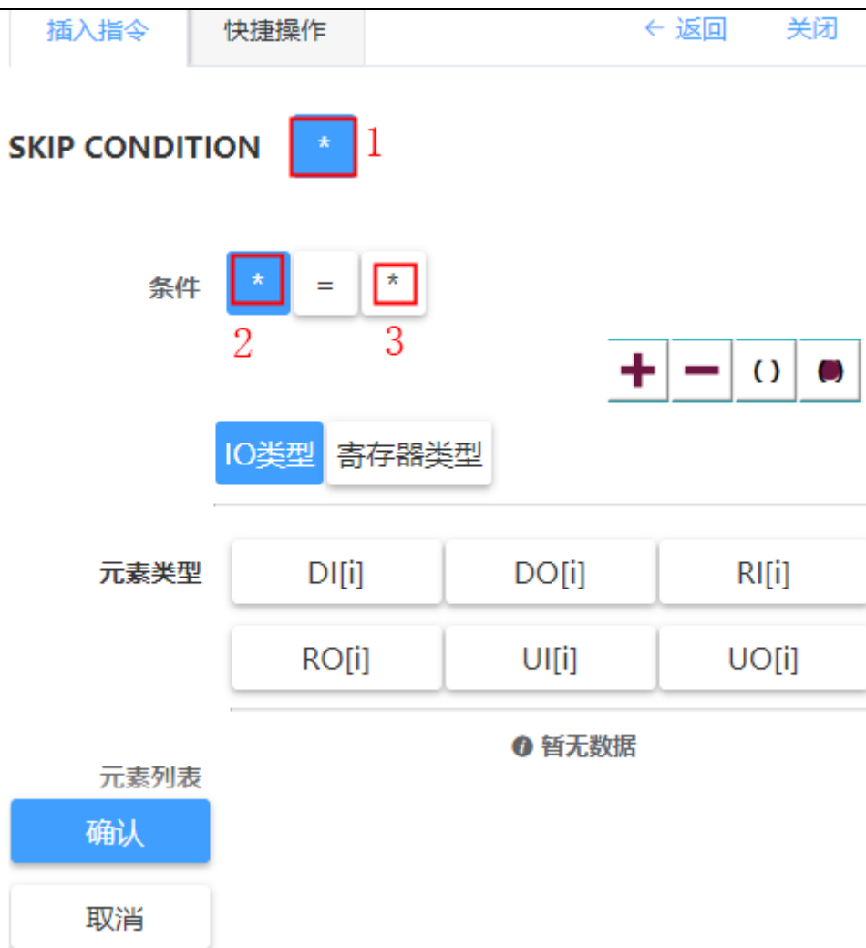
图 4.42 SKIP CONDITION 指令参数填写界面
