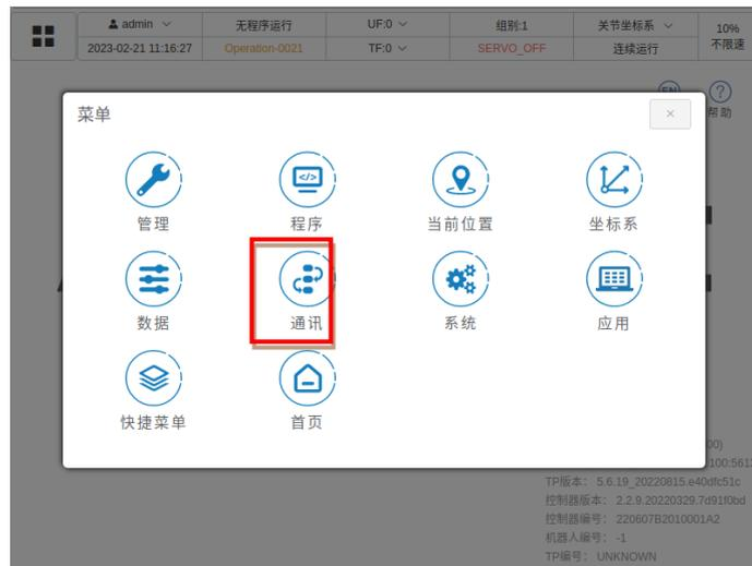
(2) 打开通讯界面后如下图，需点击 IO 状态查看 IO 信号
