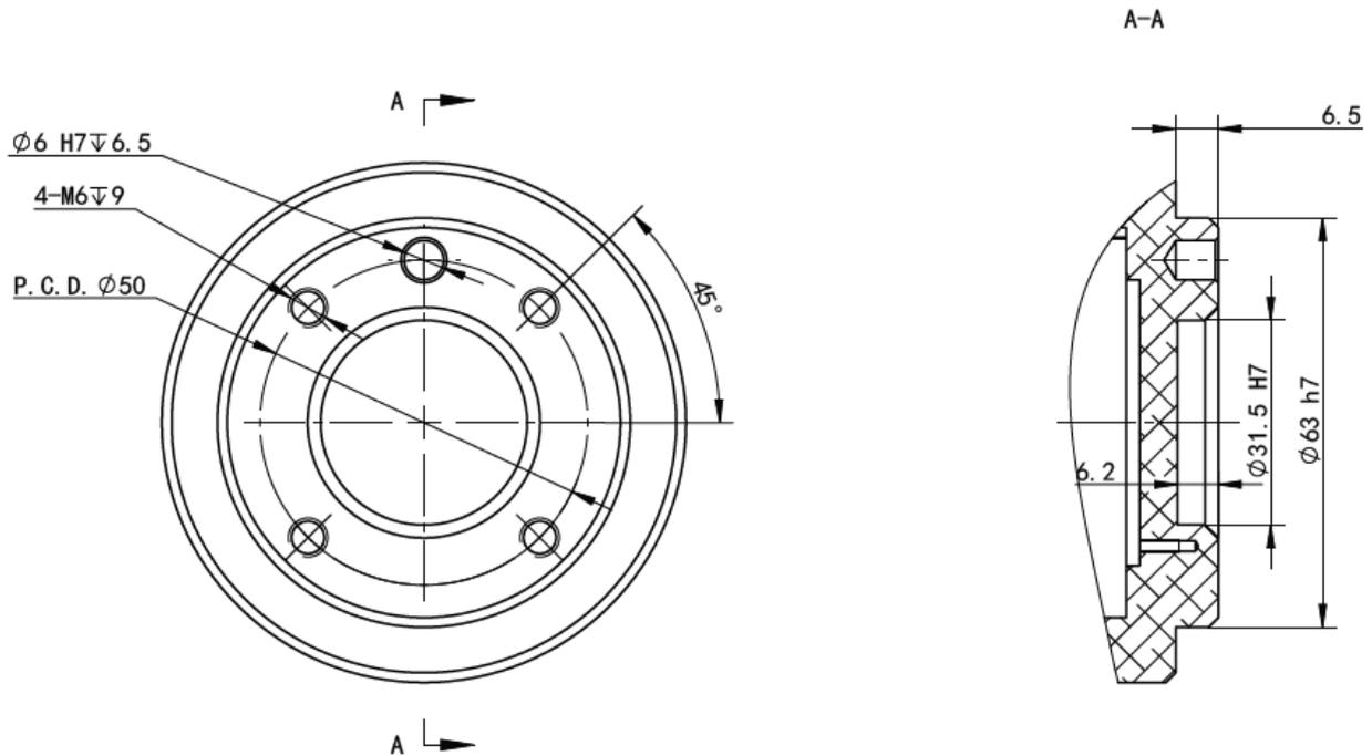
图 4.1 GBT-C5A-850 法兰尺寸图
