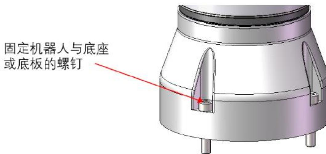
图 1. 4 固定机器人底座与底板的螺钉
