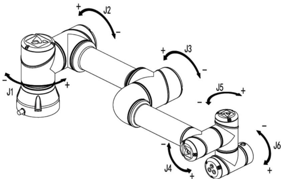
图 3.2 GBT-C5A 各运动关节及运动正方向
