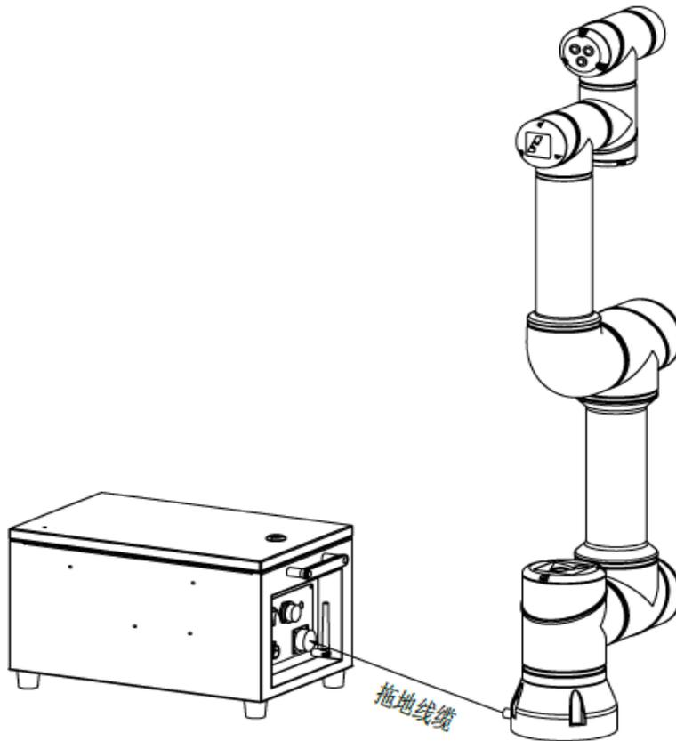
图 2.1 GBT-C5A 机器人与控制柜连接示意图
